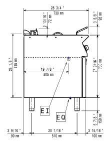
El = Connessione elettrica EQ = Vite Equipotenziale
